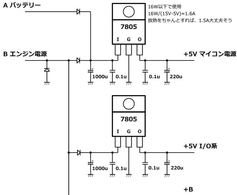
スターターを回した時に電源電圧が大きく変動するので、レギュレータの入力にダイオードと大きめのコンデンサを入れたほうが良い。そうしないとマイコンは誤動作するし、クランクアングルセンサーの波形も暴れる。
